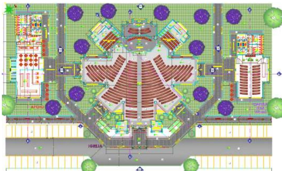
Figura 18. Planta Baixa da igreja e dos pontos de apoio (prédios laterais), sem escala.
