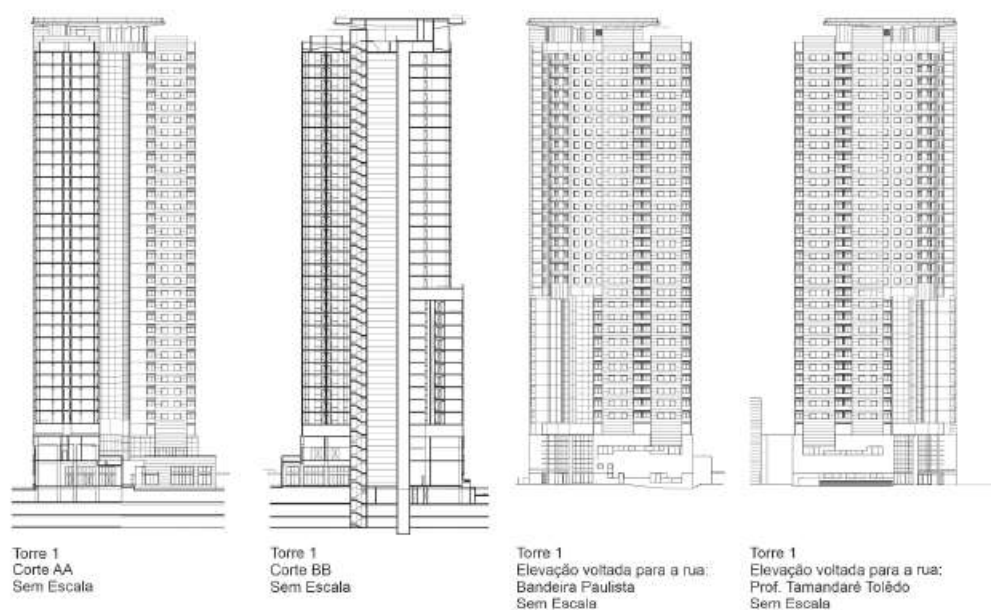
Figura 7 - Cortes e elevações da Torre 1, sem escala.
