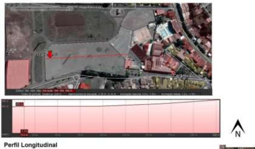
**Figura 19:** Perfil longitudinal do terreno, que será realizado o projeto. Pode-se ver que o terreno sobe em cerca de três metros.
