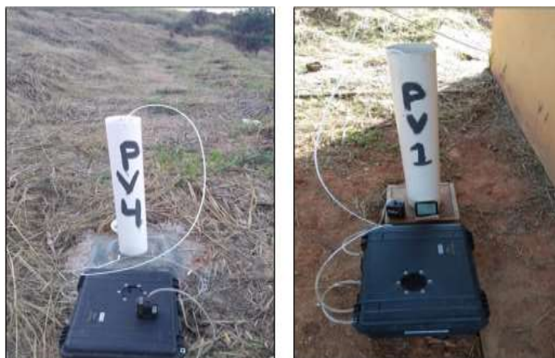
Figura 5. Amostragem de Biogás nos Poços PV-01 e PV-04 (Fonte: GPS Engenharia, 2020)
